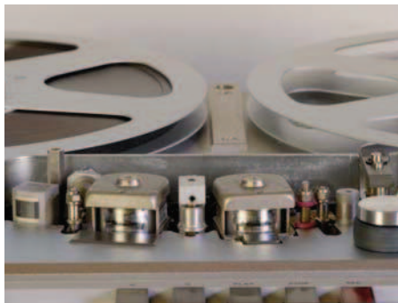
Solider Kopfträger: Die Stereo-Ausführung der B67 war häufig mit Schmetterlingsköpfen bestückt
