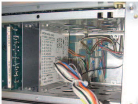
Einfache Verbindung: Der Anschluss des VU-Panels erfolgt bei der B67 MKII direkt im Schacht des Verstärkermagazins
