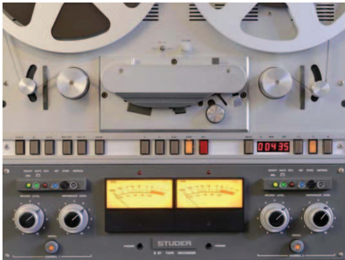
Auch in der Bedienung strikte Kanaltrennung: Die Bedieneinheiten für Aufnahme, Wiedergabe und Anzeige sind partout nicht zu verwechseln
