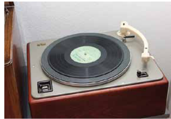
Das «Modell 60» war der erste Plattenspieler, den Revox baute und 1954 auf den Markt brachte. Der Plattenteller wird mit einem Reibrad angetrieben, mit dem Hebel links des Tellers kann unter den drei Laufgeschwindigkeiten gewählt werden. Von diesem Gerät wurden mangels Produktionskapazitäten nur sehr wenige Exemplare hergestellt.
