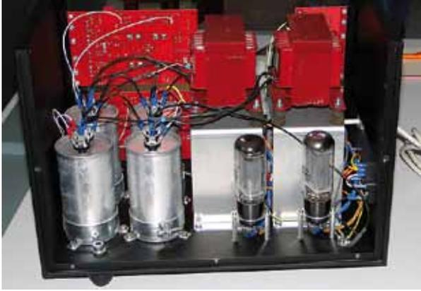
Hier der schwarze Kasten mit der Aktivelektronik für den Lautsprecher mit 300B-Röhren für den Breitbänder oberhalb 125Hz im Vordergrund.
