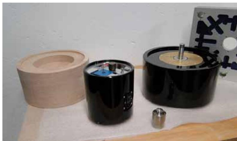
Von links nach rechts: 1. Holzrohling als Basis für das Gabriellaufwerk, 2. Motor mit Steuerelektronik aus Schweizer Produktion für das Gabriellaufwerk, 3. Koppungsfuss, welcher sowohl für die Laufwerksbasis, wie auch die Tonarmbasen verwendet wird, 4. fertige Laufwerksbasis des Gabriellaufwerks, 5. Unterseite des «günstigeren» Laufwerkes (man beachte die Ausfräsungen, welche mit einem Kunststoffgemisch gefüllt werden).
